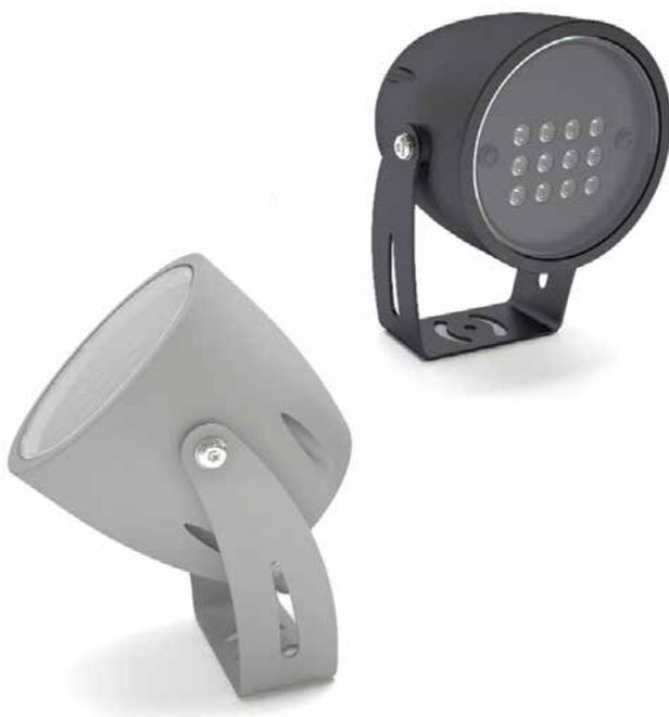
**eCOLOR 12** ist prädestiniert für die Ausleuchtung architektonischer Details. Das aus einer eloxierten Aluminiumlegierung bestehende Gehäuse ist in schwarz oder silberfarben verfügbar. Verschiedene Ausstrahlungswinkel und die Ansteuerung über DMX512 sind weitere Merkmale dieser Leuchte. Die Stromversorgung und das DMX-Pult sind im Gehäuse integriert.
