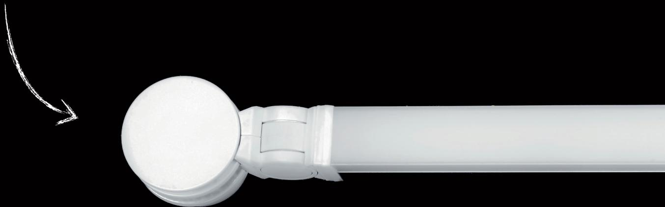
Die Knoten übernehmen nicht nur die Aufgabe der Verknüpfung der Leuchtstäbe sowie der Stromweiterleitung – sie bilden gleichzeitig auch die Ankerpunkte für die Montage. Nur eine einzige Schraube wird benötigt, um einen Knoten an einer Wand oder Decke zu befestigen. Neben der Schrauboption gibt es auch Knoten mit Aufhängevorrichtung oder Magneteinsatz.
