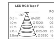
**Besonderheiten:** max. 5 m pro Anschlussleitung; schnelle und einfache Montage durch doppelseitiges Klebeband; Streifen alle 50 mm kürzbar; die Streifen lassen sich anschliessend nicht wieder kontaktieren; Minimaler Biegeradius 50 mm; Dank IP54 ideal geeignet für Anwendungen mit erhöhter Schutzart (allg. Feuchtigkeit, Bad- und Küchenbereich, Frischebereich, Ladenbau); Flächenlicht (keine sichtbaren Lichtpunkte)
